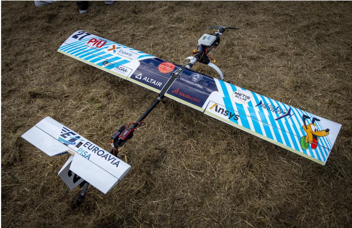
L'aeromodello sviluppato per l'occasione – simpaticamente denominato Pluto – ha una struttura solida ed essenziale costituita da tubi in fibra di carbonio collegati all'ala mediante un giunto in alluminio. L'ala ha forma in pianta rettangolare e presenta un profilo curvo, mentre la coda ha una configurazione a T con profilo simmetrico. Entrambe sono realizzate in legno.
